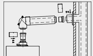
Longitud máxima entre caldera y chimenea: 10 m + 1 codo 87°
