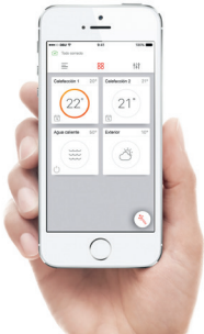
Sistema de telegestión vía internet Programación inteligente, control de su caldera mediante App (termostato inteligente+App).
